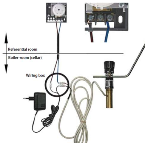
No outro caso, ambas as extremidades dos fios do cabo de alimentação do regulador são conectadas ao fio do adaptador eléctrico, ligado a uma tomada de 230 V controlada por um termostato.
