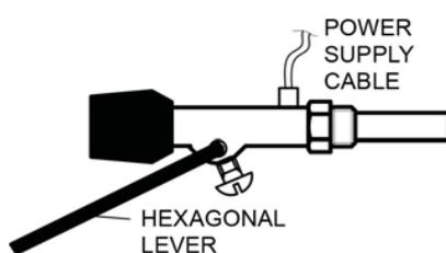
Aparafuse o regulador com sua rosca externa G3/4" em uma conexão na caldeira com rosca interior G3/4". Sele a rosca (por exemplo, com selante Teflon em fita etc.).
