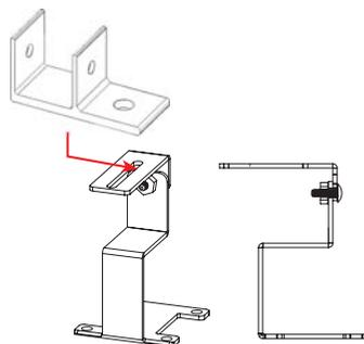
O carril pré montado será fixado directamente às salva-telhas mediante a "F"
