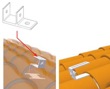
Atenção: As medidas que se fornecem na pág. 6 correspondem ao centro dos furos das pinças, pelo que coincidem com os pontos de fixação das salva-telhas. Especifica-se na pág. 7 as medidas para as salva-telhas.
