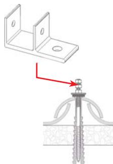
O carril pré montado será fixado directamente ao parafuso mediante a "F"
