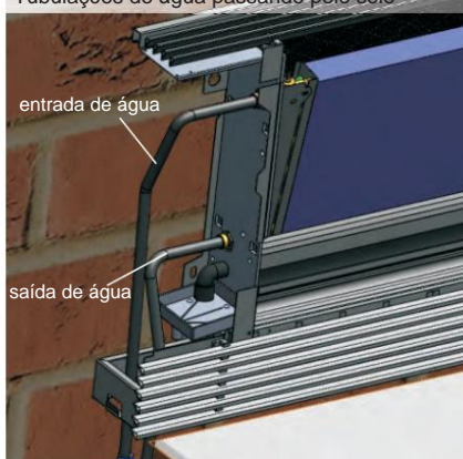
Tubulações de água passando pelo solo
