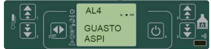
fig. 43 painel de comandos - alarme ventilador de aspiração de fumos
