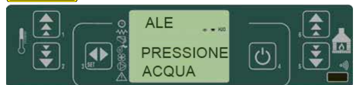
fig. 46 painel de comandos - pressão da água
