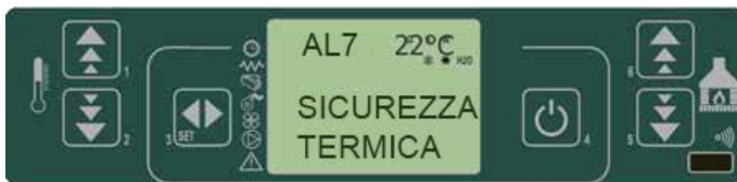
fig. 42 painel de comandos - alarme por termóstato geral
