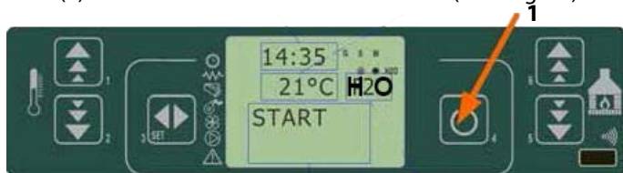
fig. 27 painel de comandos - acendimento
