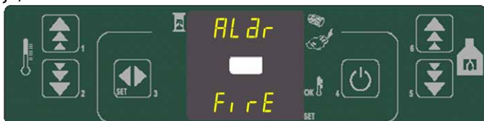
fig. 33 panel de mandos - alarma apagado durante funcionamiento
