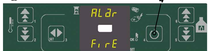
fig. 37 panel de mandos - encendido del pellet fallido
