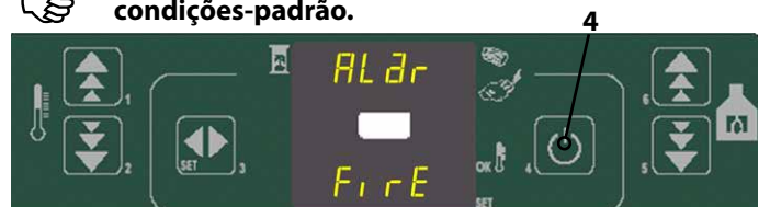
fig. 37 painel de comandos - falha no acendimento dos pellets
